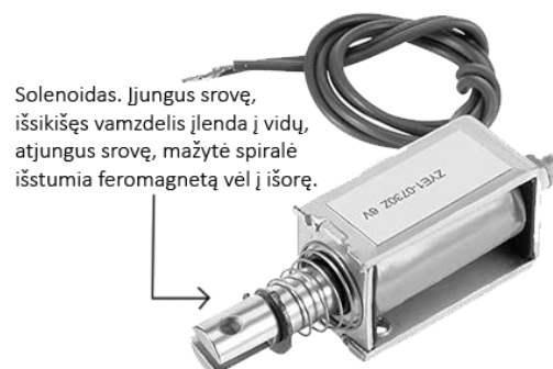
(Pav. 2) Solenoido veikimo principas
