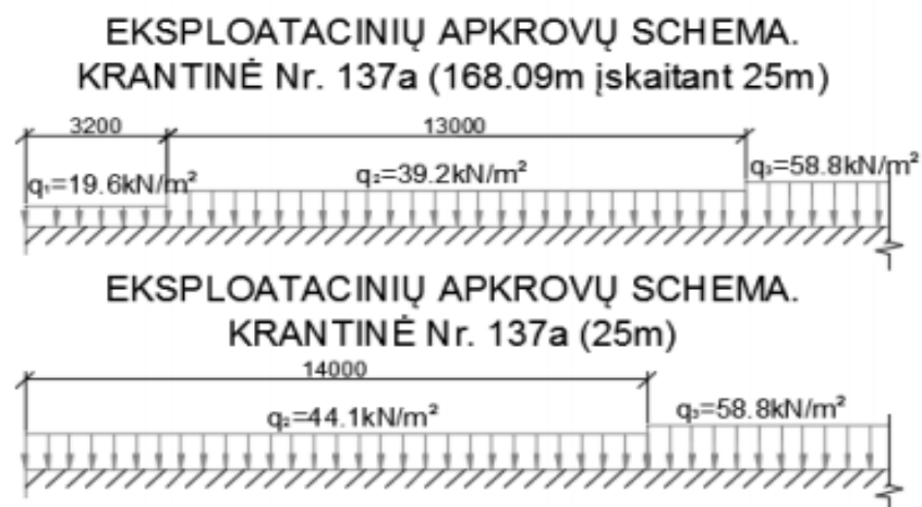
22 pav. Krantinės Nr. 137A apkrovų schema
