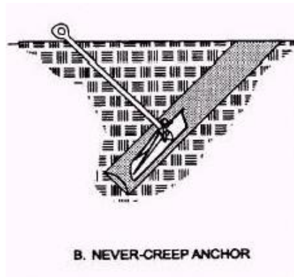
3 pav. „Never-Creep“ inkaro schema (Littlejohn 1997)
