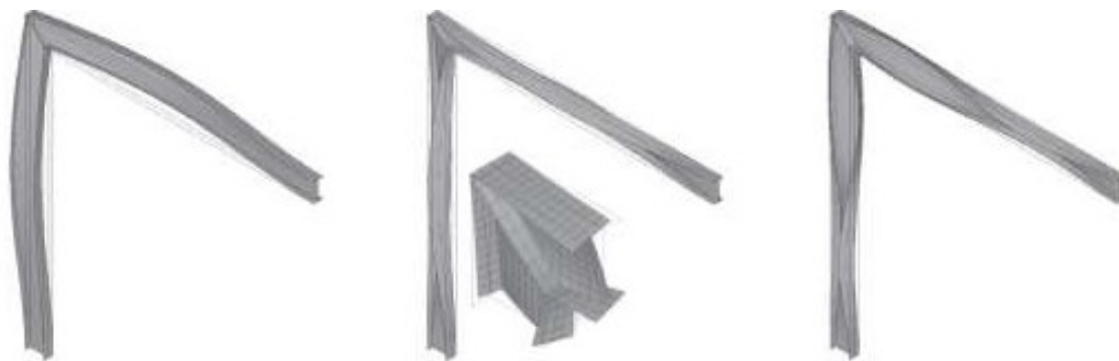
5 pav. Svyravimo formų vaizdavimas su ANSYS programine įranga
