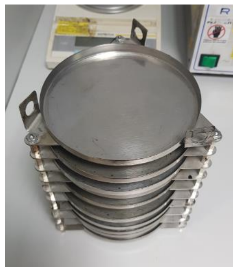
13 pav. Lėkštelės naudojamos PAV sendinimui
