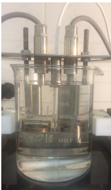
16 pav. Indas su vandeniu ir bandiniu minkštėjimo temperatūros nustatymui
