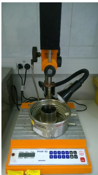
17 pav. Prietaisas adatos penetracijai nustatyti
