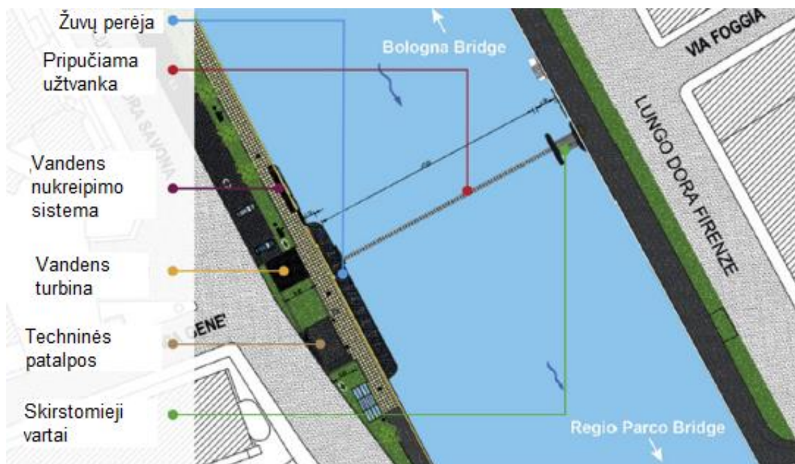
17 pav. Techninis žemėlapis parodantis mini HE statinių specifikaciją (Comino et al. 2019).
