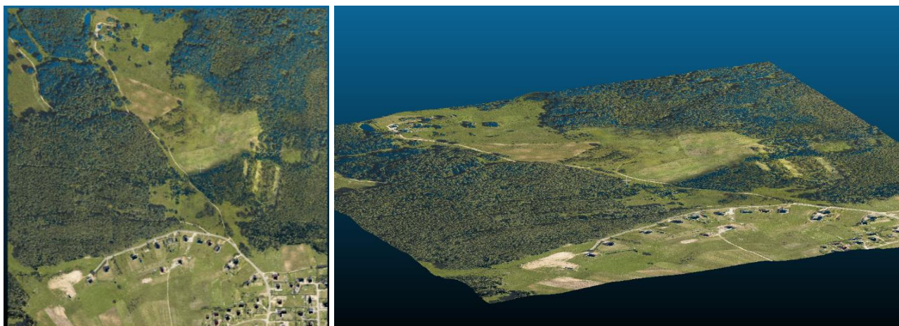
4.29 pav. LasTools suklasifikuota žemės klasė: 2D aplinkoje (kairėje), 3D aplinkoje (dešinėje)
