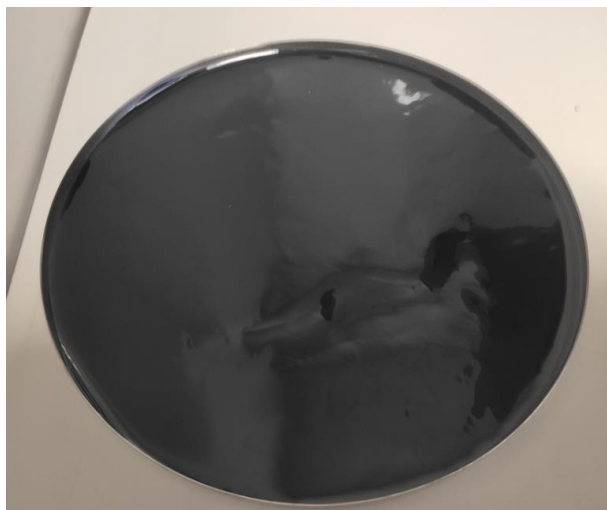
16 pav. Bitumas lėkštelėje ilgalaikiui sendinimui
