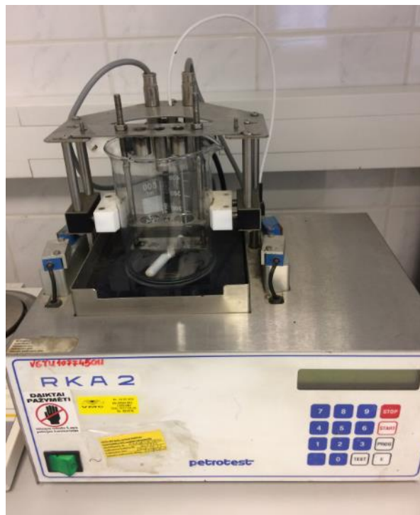
12 pav. Minkštėjimo temperatūros nustatymo prietaisas
