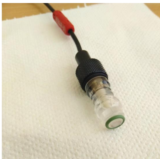
2.3 pav. Elektrocheminei analizei naudojamas Klarko deguoninis elektrodas.
