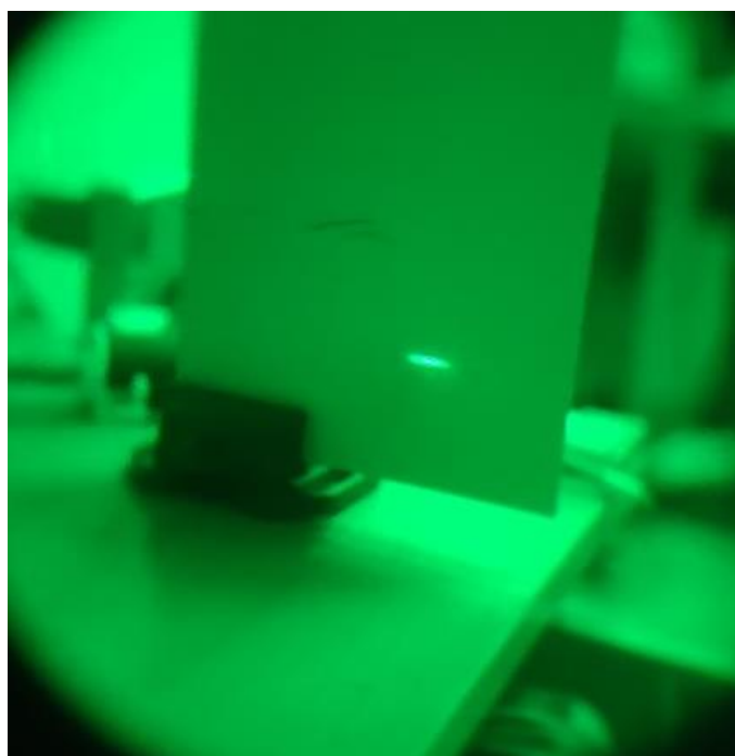
7.9 pav. Lazerinio diodo kolimuota šviesos pluošto forma
