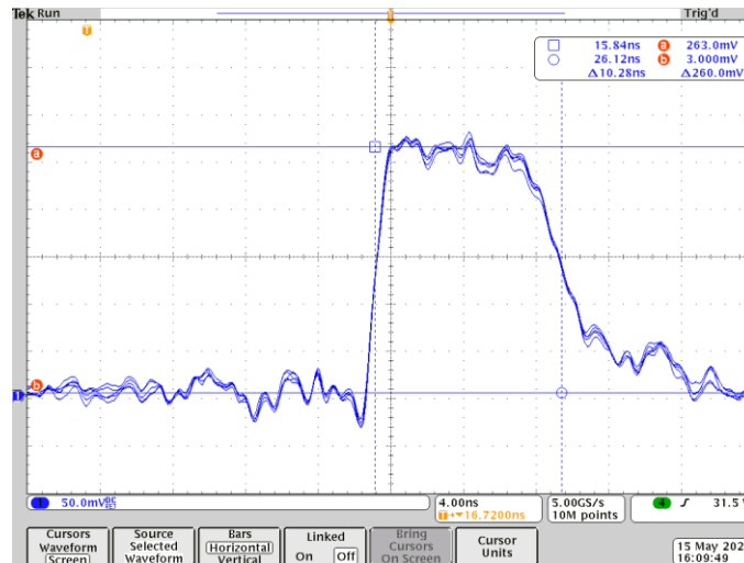
7.5 pav. Imtuve suformuoto elektrinio impulso oscilograma
